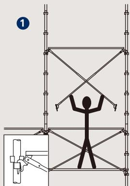
作業床より支柱の6個目のポケット位置(2700mm)に上部取付金具を差し込みます。
