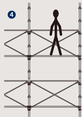
最後に床付布枠を取り付け、常に手すりがある状態で上階へ進みます。
