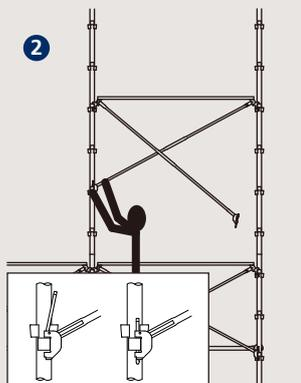
次に筋かい部分をクロスさせ、下部取付金具のくさびを支柱ポケットに差し込みハンマーで打ち込みます。
